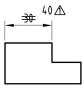
(A) 重要尺度 (B) 參考尺度 (C) 功能尺度 (D) 修改尺度
